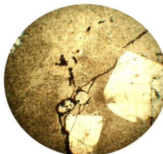
Фиг. 6. Андезит порфировый, лава, юра. Фиг. 7. Кварцевый порфир (посередине видна Ув. 2,5х10; без анализатора. тень кпш), лава, юра. Ув.2,5х10; без анализ.
