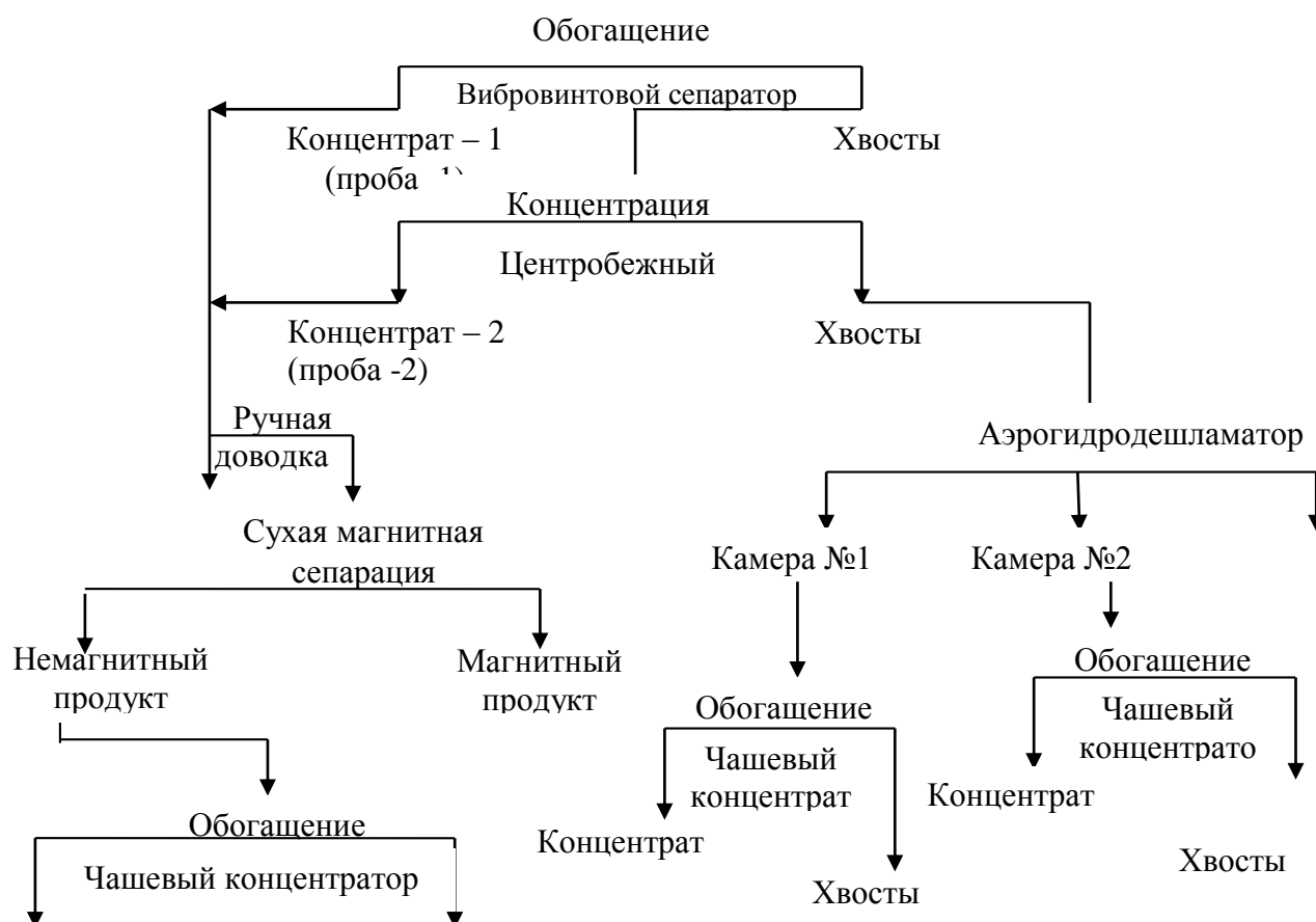
Рис. 1. Технологическая схема гравитационного обогащения
