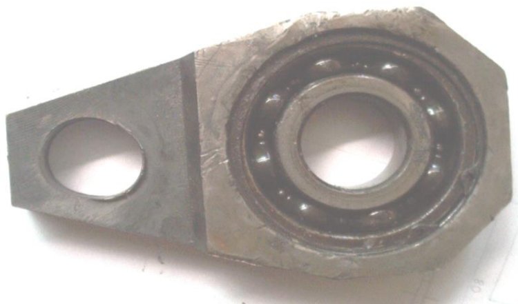
Рис.9. Образование эллипса в отверстии шатуна ударного механизма
