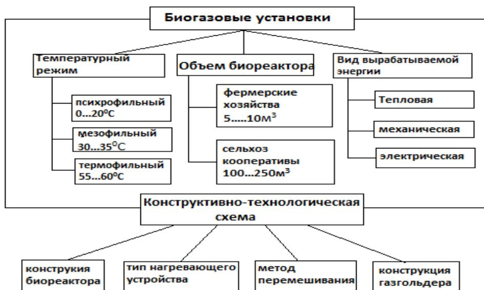
Рис.1. Классификация биогазовых установок
