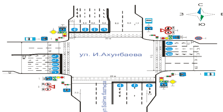
Рис.8. Предлагаемая схема организации движения на пересечении улиц И.Ахунбаева – Байтик баатыра
